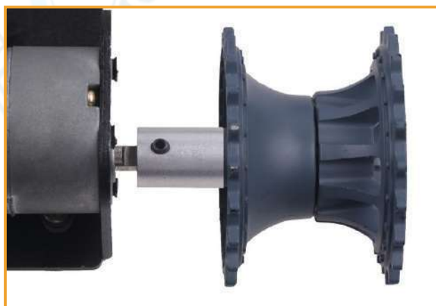
Рис. 16. Установленное ведущее колесо.
