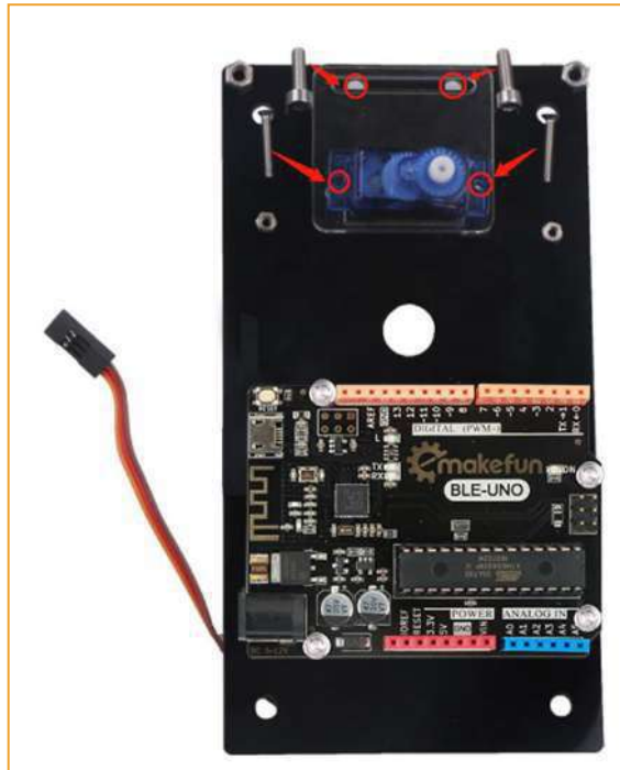
Рис. 22. Схема установки сервопривода.
