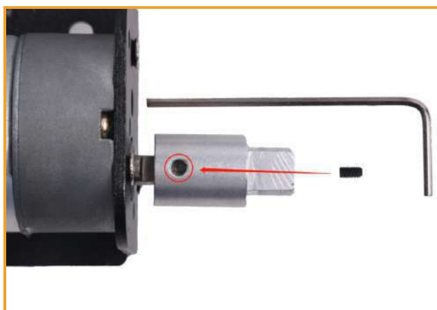
Рис. 13. Крепление муфты на валу электродвигателя.
