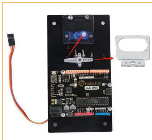
Рис. 26. Схема установки кронштейна ультразвукового датчика.
