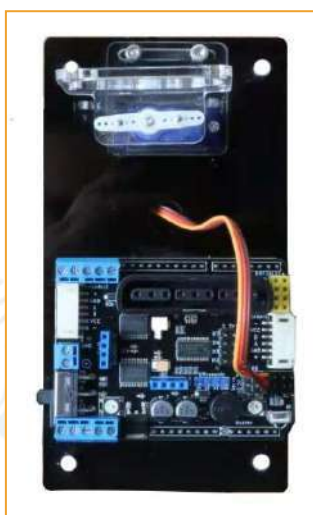
Рис. 28. Установленный кронштейн ультразвукового датчика.
