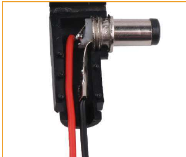
Рис. 6. Схема подключения проводов питания.
