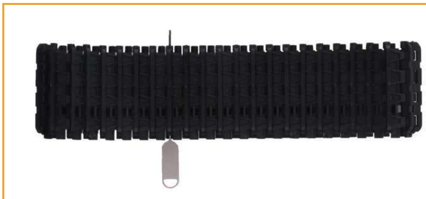
Рис. 17. Расцепление гусеничной ленты.
