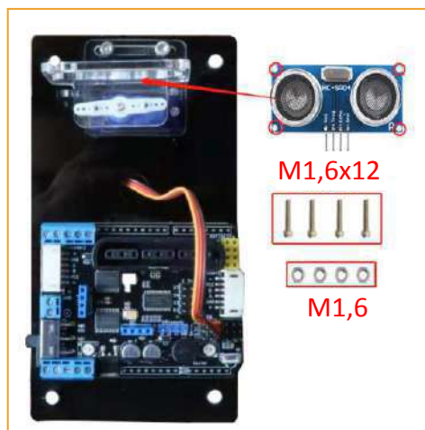
Рис. 29. Схема установки ультразвукового модуля и платы расширения.
