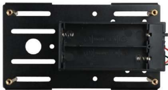
Рис. 4. Установка аккумуляторного отсека.
