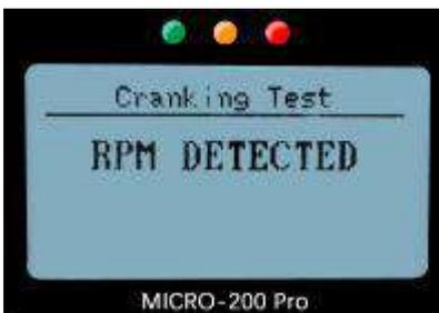
Когда тестирование завершится, на экране отобразятся данные о напряжении запуска и времени запуска. Нормальным считается напряжение выше 9,6 В.
