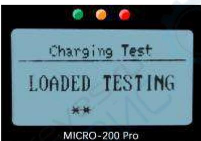
**Примечание: не глушите двигатель во время тестирования. Во время тестирования вся электрическая нагрузка в автомобиле должна быть ВЫКЛЮЧЕНА, в противном случае результаты теста могут быть некорректными.**
