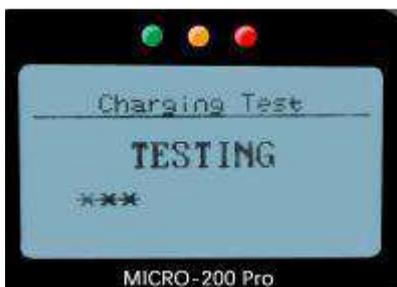
После завершения тестирования на экране отобразятся следующие результаты: напряжение заряда, результаты теста пульсации и общий результат тестирования аккумулятора.
