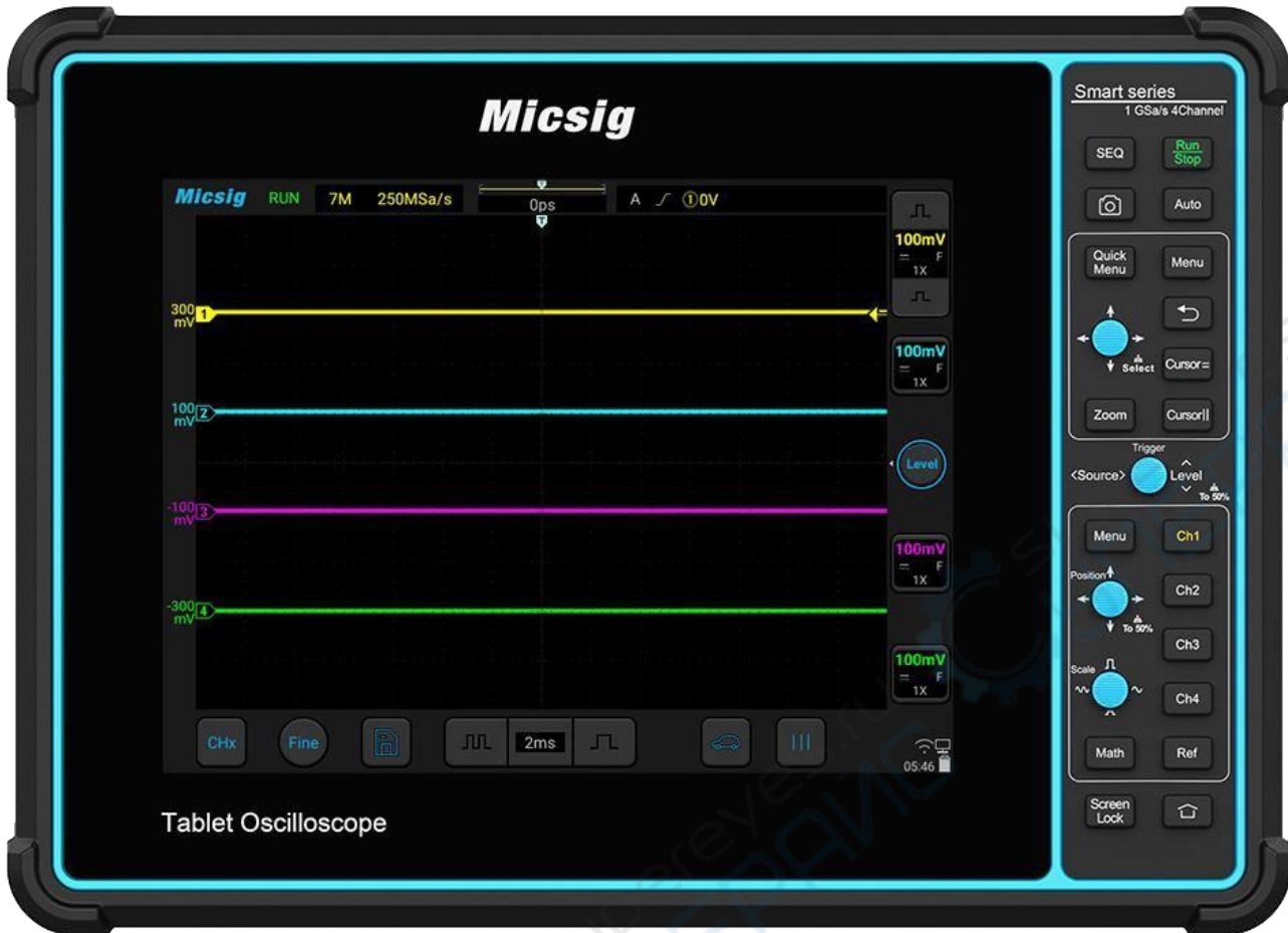
Рисунок 2–5 Передняя панель настольного осциллографа
