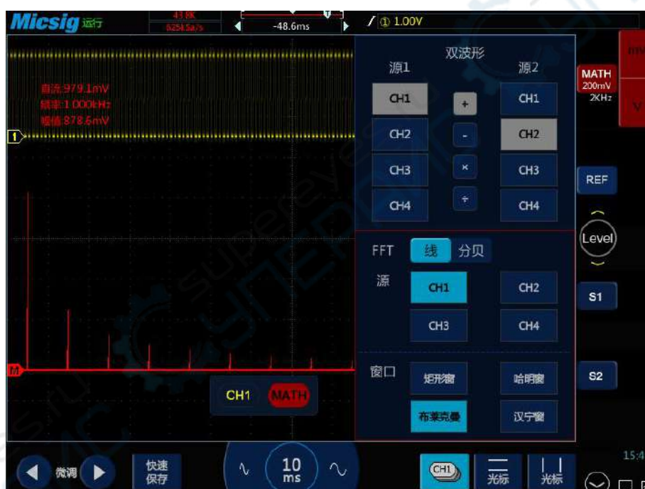
图9-4 频谱幅度为 V-Hz 示意图
