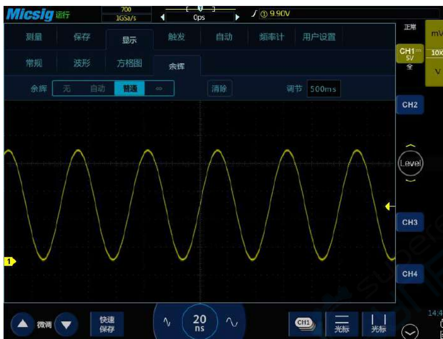
图10-4 20MHz 正弦波可变余辉 500ms 示图
