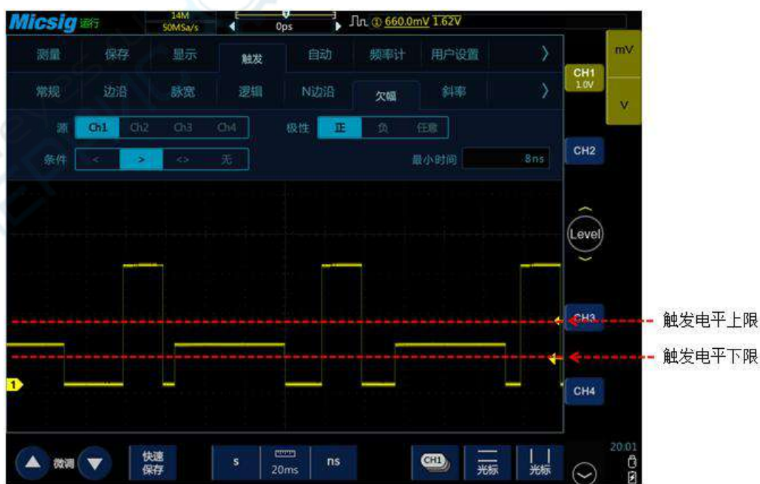
图6-24 欠幅触发设置菜单
