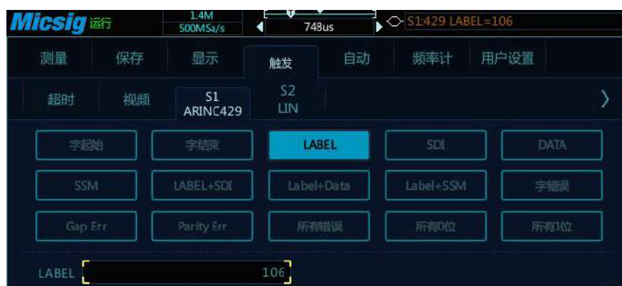
图12-26 ARINC429 触发方式配置菜单
