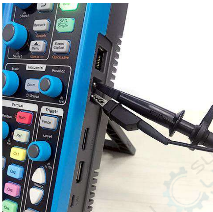
图2-13 探头连接方式
