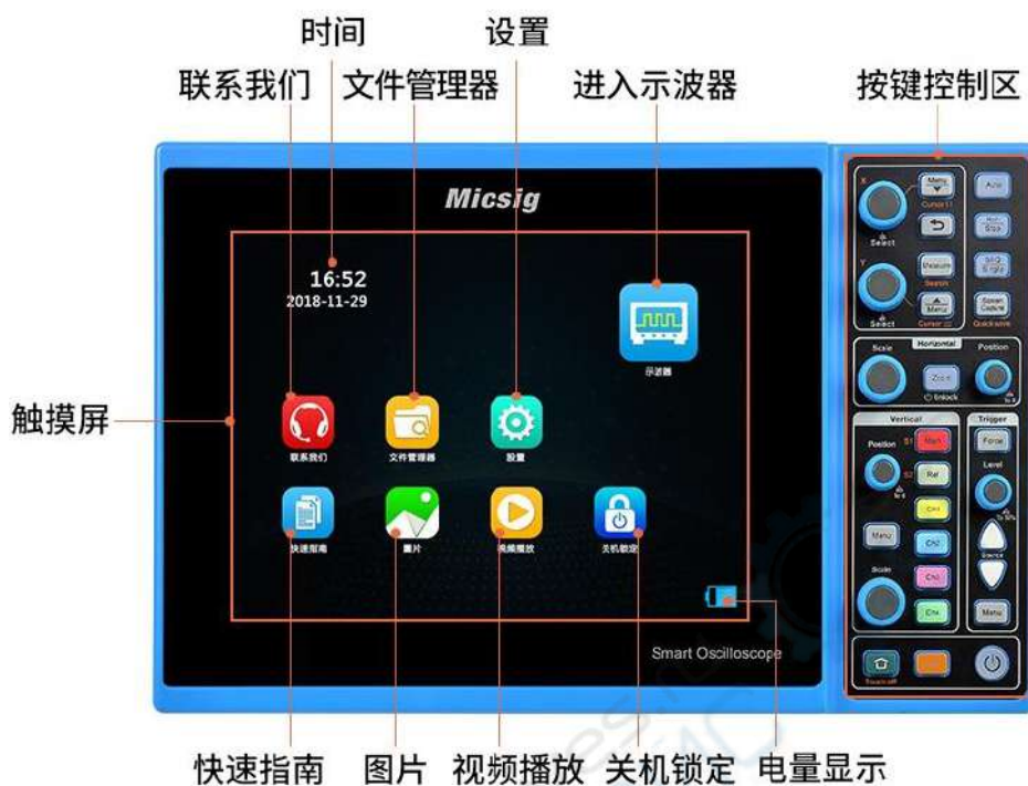
图2-4 平板示波器前面板
