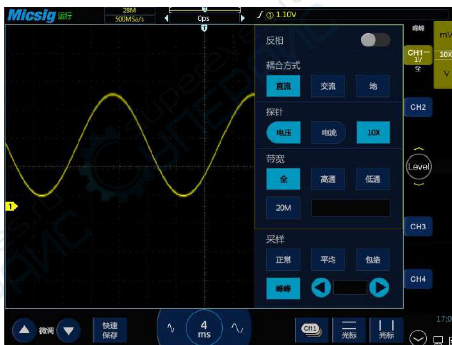
图11-6 带毛刺的正弦波，峰值采样模式
