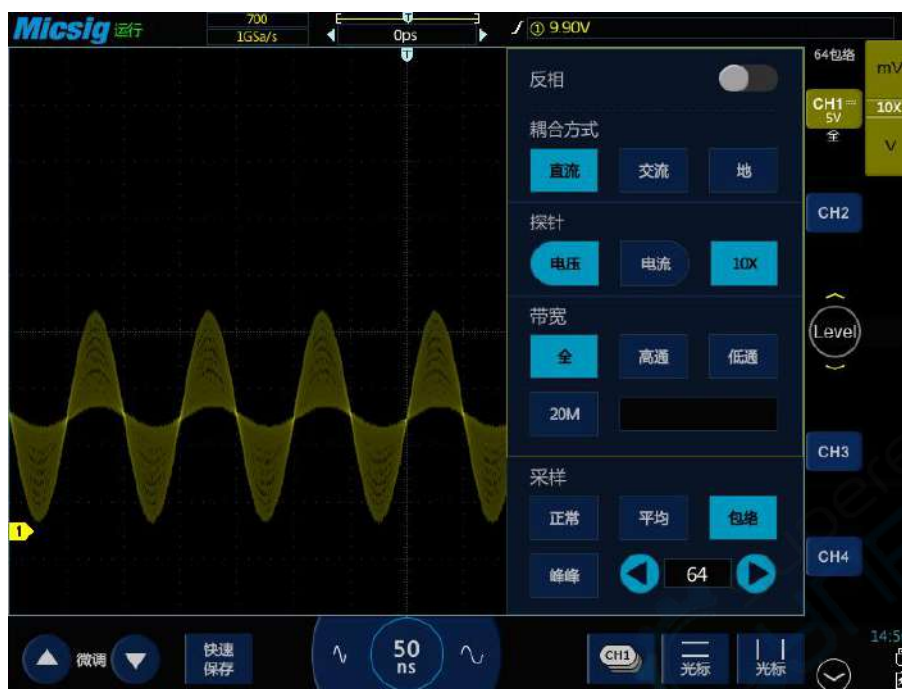
图11-8 包络采样模式（64）下的调幅信号
