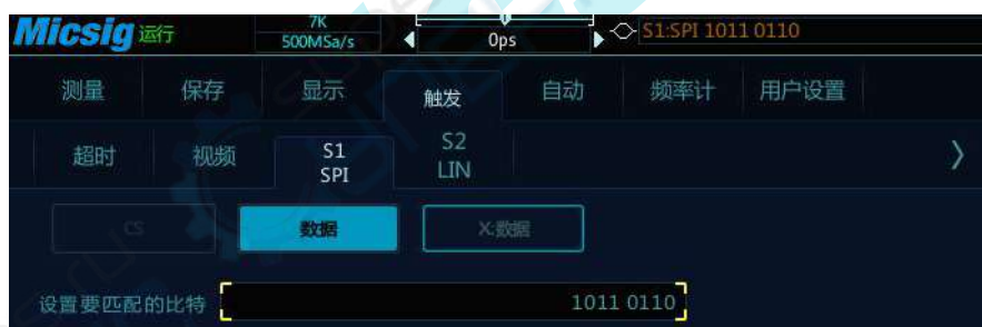
图12-18 SPI 触发方式配置菜单
