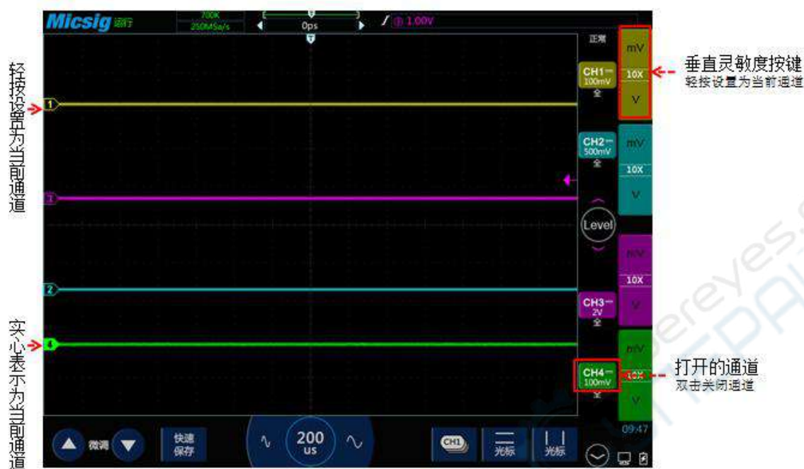
图5-4 通道的打开、关闭与切换
