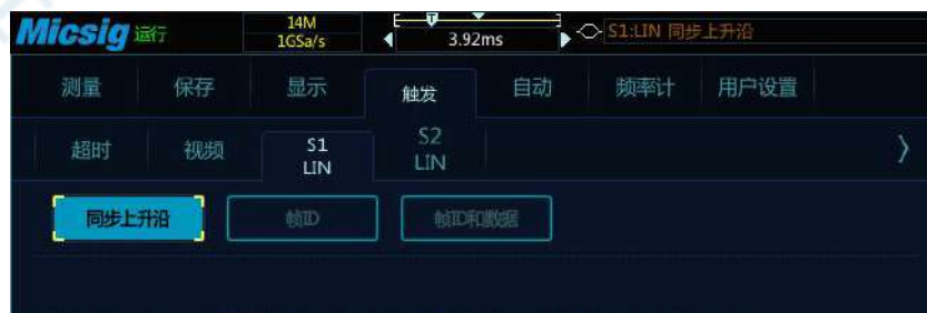
图12-10 LIN 触发方式配置菜单
