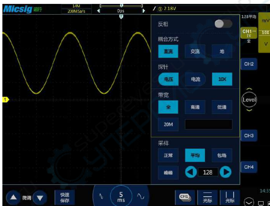
图11-7 选择平均采样模式后的波形，平均数 128
