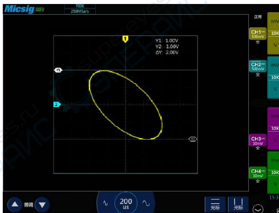
图7-12 XY模式中，光标测量
