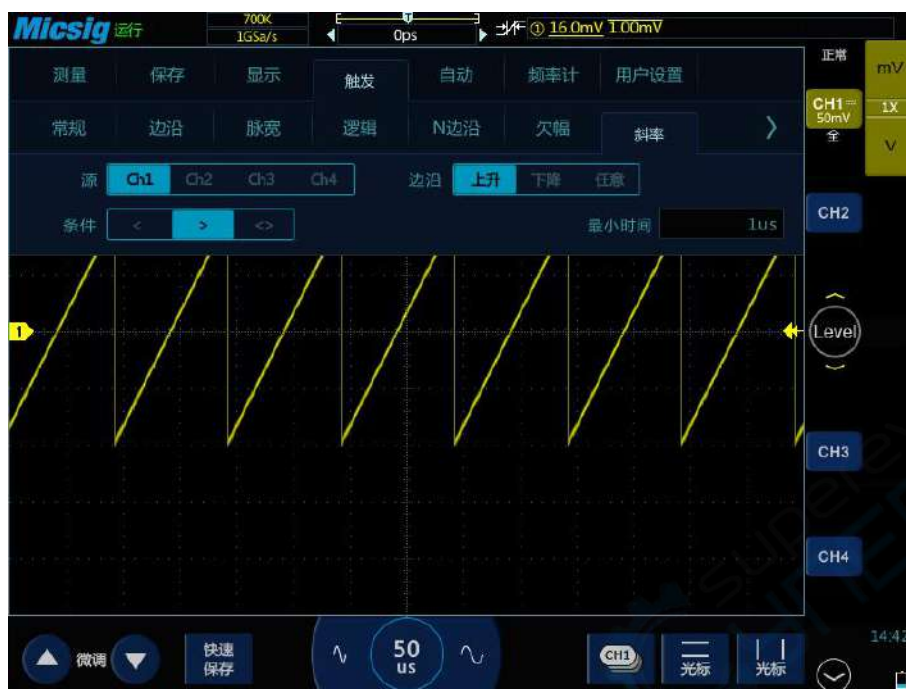
图6-26 斜率触发设置菜单
