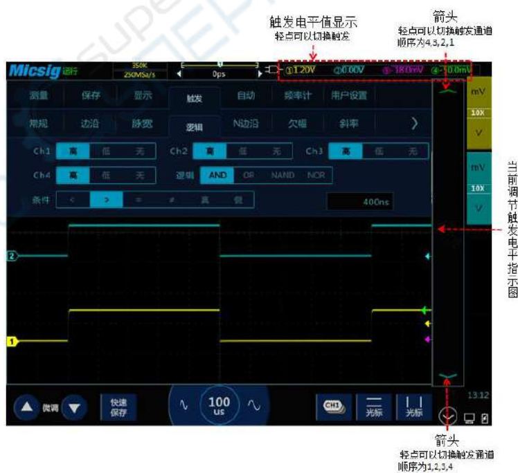
图6-21 触发电平调节
