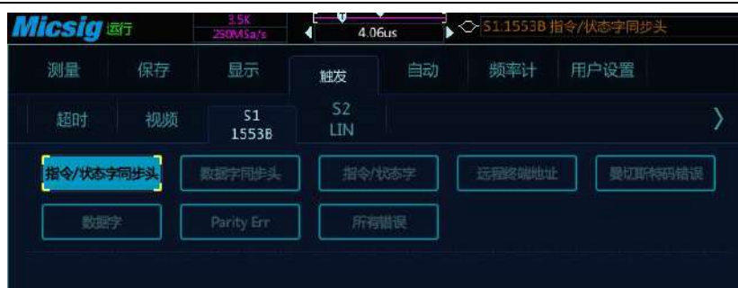
图12-30 1553B 触发方式配置菜单
