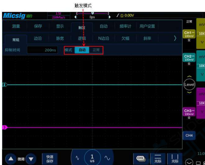
图6-5 示波器触发模式设置
