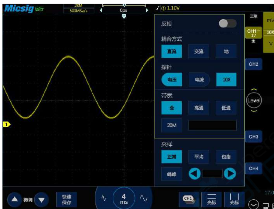
图11-5 带毛刺的正弦波，正常采样模式
