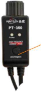
Автоматическое обнуление смещения постоянного тока: Включите пробник, нажмите кнопку с красным светодиодом, затем сразу же уберите руку. (Используйте эту функцию перед тестированием постоянного тока, а для тестирования переменного тока она не нужна).
