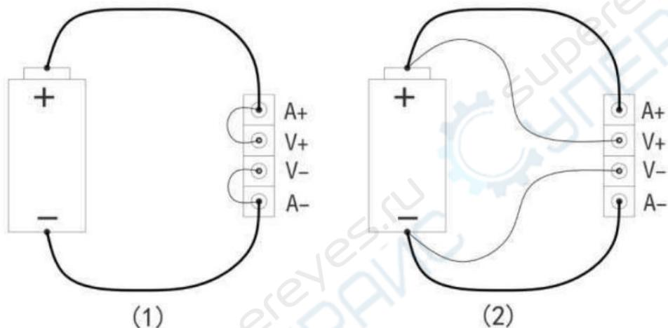
На рисунке 1 показана двухпроводная схема подключения. Этот метод относительно прост и удобен (**Примечание:** подключение должно осуществляться к двум клеммам [A+] и [A-]).
