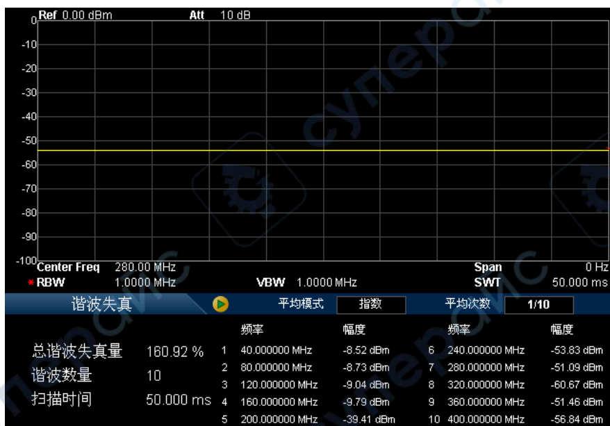
图 2-20 谐波失真测量界面
