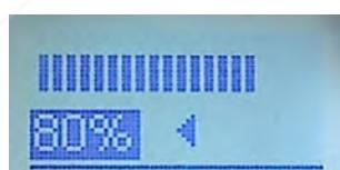
Для инструмента термозачистки указатель всегда направлен влево и нажатием на кнопку «●» переходят в режим изменения мощности нагрева. В режиме изменения мощности прямоугольный указатель выделяет численное значение заданной мощности, а кнопками «◀» и «▶» можно изменять это значение в пределах от 5% до 100%. Для завершения изменения и сохранения нового
