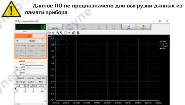
Слева вверху необходимо выбрать № порта и нажать кнопку «Online», ПО подключится к прибору. Активируется виртуальная клавиатура, из прибора будут считаны: Модель (model), установленная единица измерения (Unit), верхний и нижний пороги (up limit и low limit), максимальное значение силы для данного прибора (CPDT). Виртуальный дисплей будет отображать значение с учётом положения десятичной точки. Если считывание параметров прибора не произошло, нажмите кнопку «Offline» выбе-
