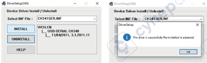
Подключите прибор к ПК, и включите его. Windows обнаружит и установит устройство. При правильной установке драйвера в диспетчере устройств, в разделе «Порты COM и LPT» появится порт «USB-SERIAL CH340», как на картинке. Нумерация порта может быть другой, запомните его номер.
