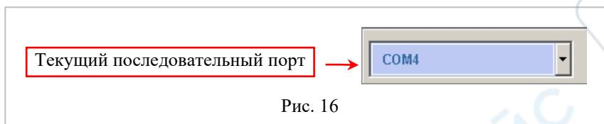
Для установки связи с подключённым к компьютеру прибором необходимо выбрать последовательный порт, к которому подключен МИТ 8.20 из списка доступных портов.
