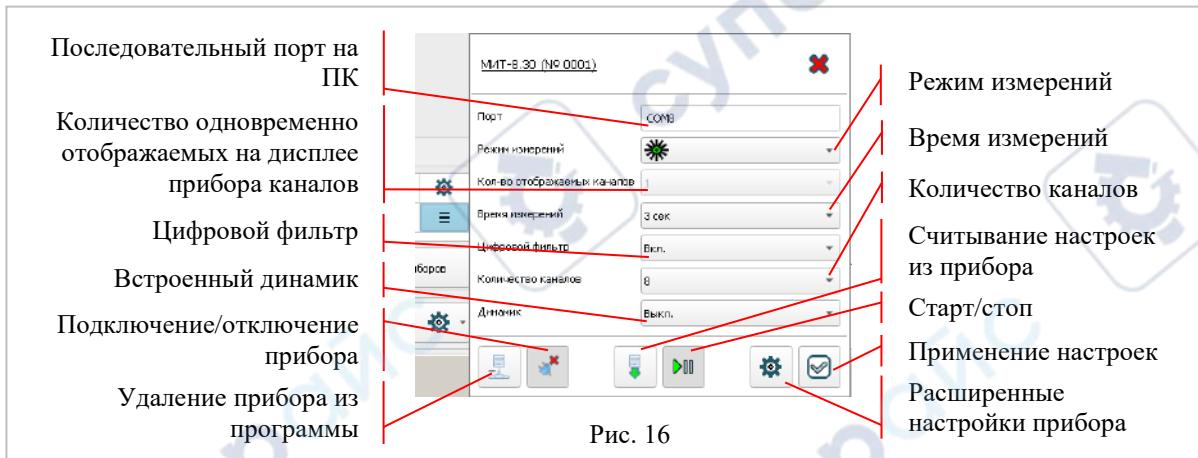
«Последовательный порт на ПК» - RS-232C или виртуальный последовательный порт, к которому подключен МИТ 8.30.
