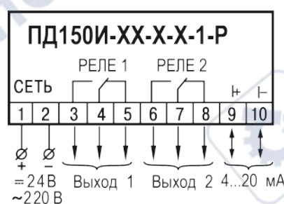
Рисунок 5.2 – Назначение контактов клеммника преобразователя с аналоговым выходом
