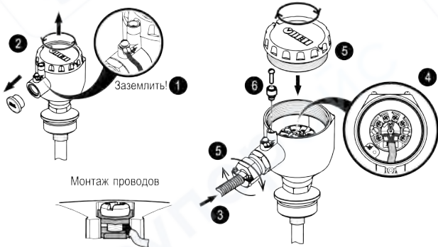
Рисунок 5.2 – Монтаж внешних электрических цепей
