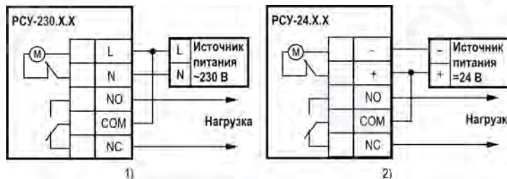
Рисунок 5.3 – Схема подключения для 230 В (1) и 24 В (2) модификаций
