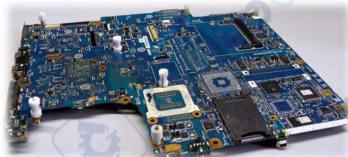
Вид платы с установленными фторопластовыми стойками с нижней стороны
