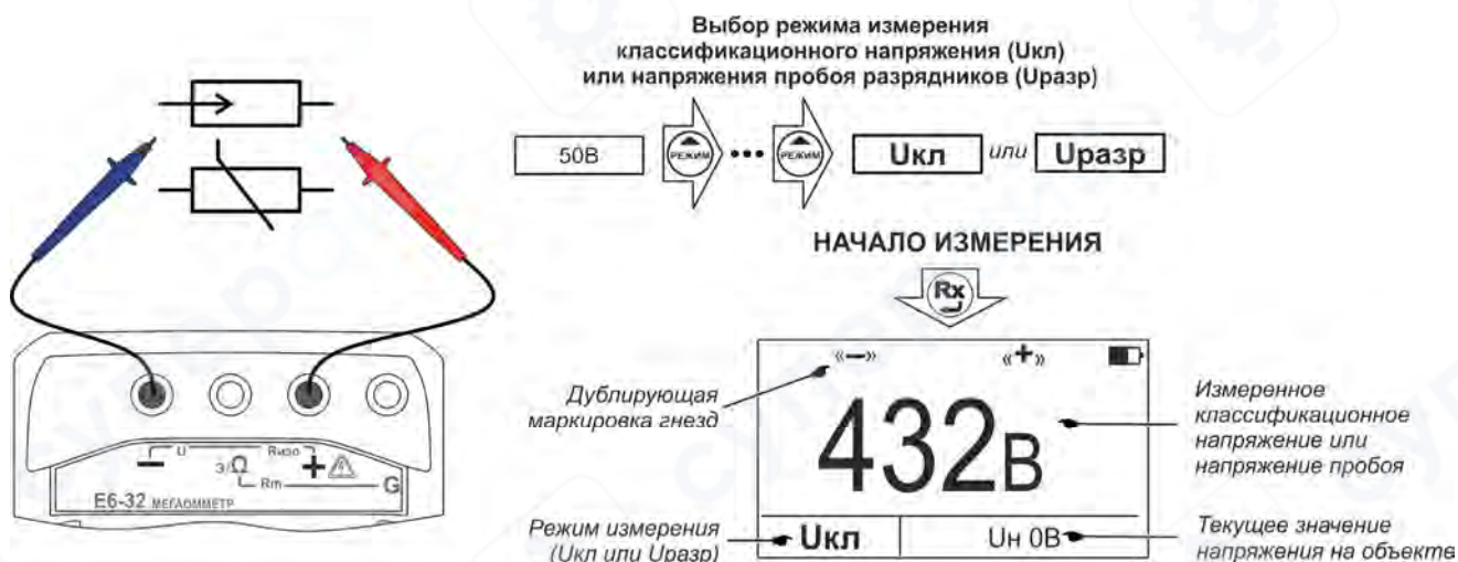
Рисунок 2.10 - Измерение классификационного напряжения или напряжения пробоя разрядников
