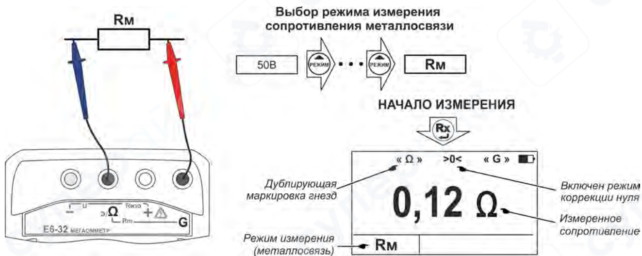
Рисунок 2.8 - Измерение сопротивления металlosвязи
