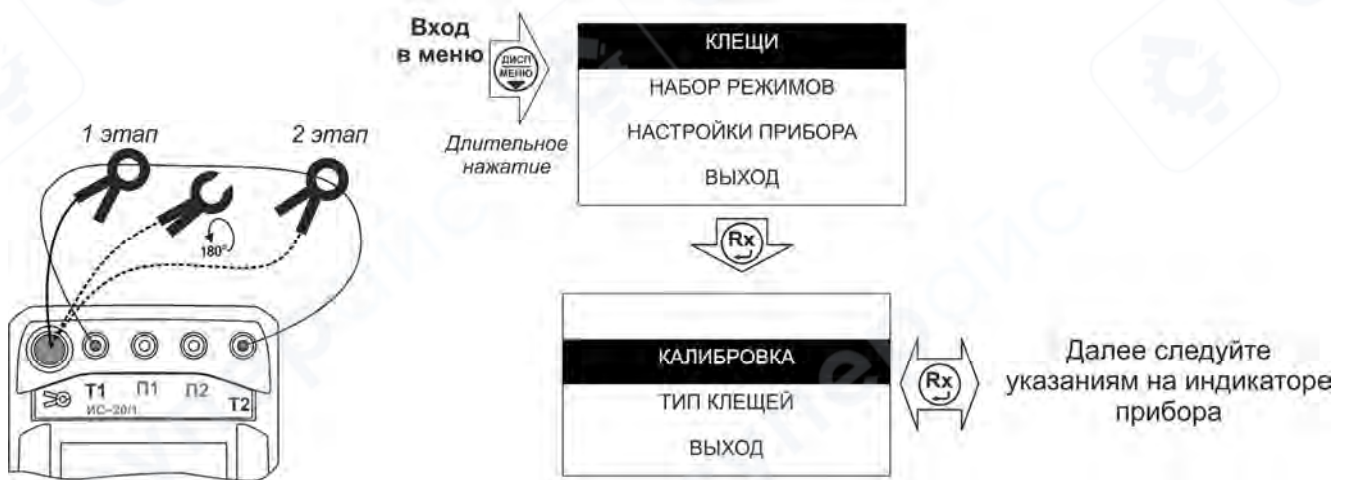
Рисунок 2.14 – Калибровка токоизмерительных клещей
