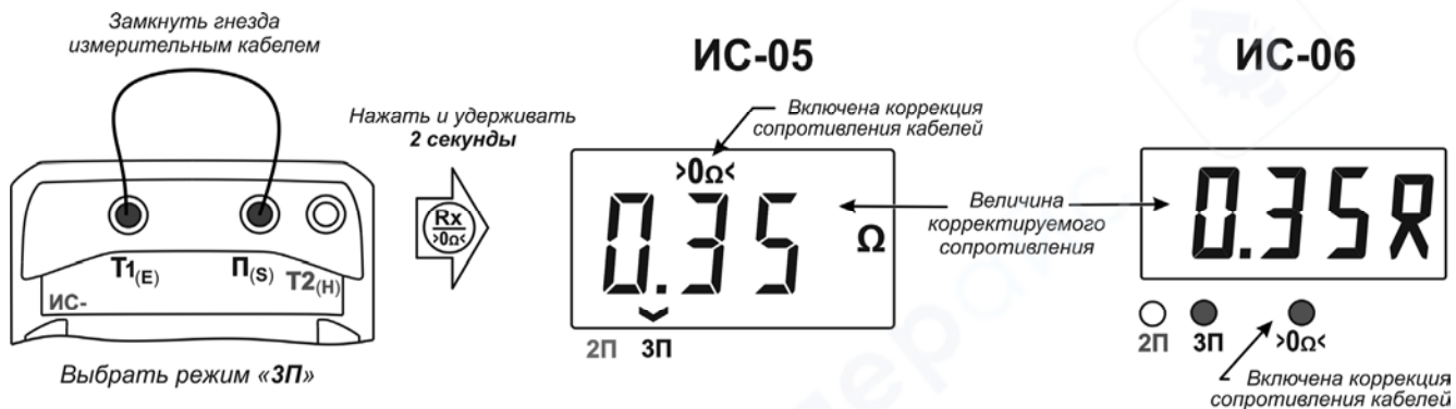
Рисунок 3 – Коррекция сопротивления измерительного кабеля (3П)
