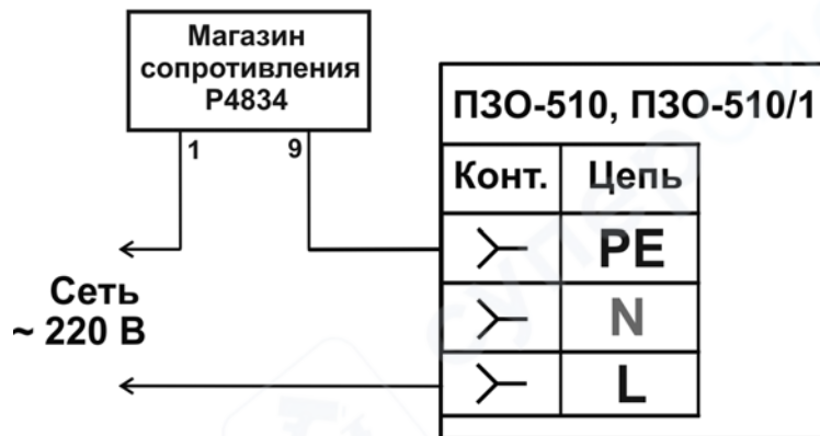
Рисунок 6.7.5 - Схема проверки погрешности измерений напряжения прикосновения
