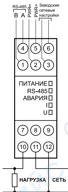
Рисунок 5.1 – Подключение прибора к однофазной сети
