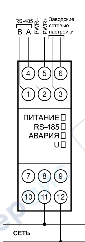
Рисунок 5.1 – Подключение прибора к однофазной сети
