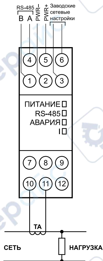
Рисунок 5.2 – Подключение прибора к однофазной сети через согласующий трансформатор
