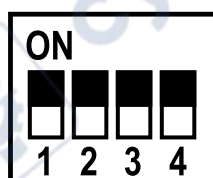
Рисунок 6.3 – Внешний вид DIP-переключателей (все переключатели отключены (в положении «OFF»))
