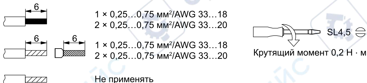
Рисунок 5.1 – Рекомендации для проводов
