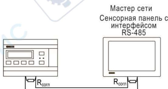
Рисунок 6.15 – Типовая схема подключения для ПР200 в режиме Slave
