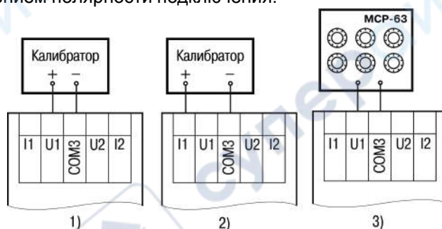
Рисунок Б.1 – Подключение источника эталонного сигнала
