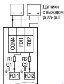
Рисунок 6.2 – Подключение к входам типа «ДС» датчиков с выходом push-pull
