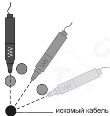
Рисунок 5.4.2 – Отбор жилы по минимуму сигнала
