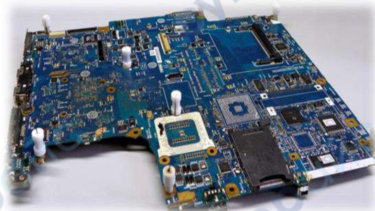
Вид платы с установленными фторопластовыми стойками с нижней стороны
