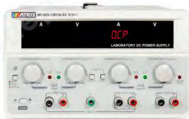
Указание на срабатывание защиты OCP на CH2
