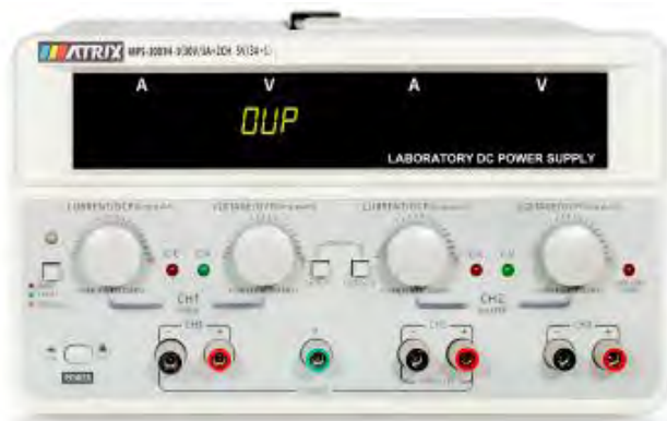
Указание на срабатывание защиты OVP на CH1
