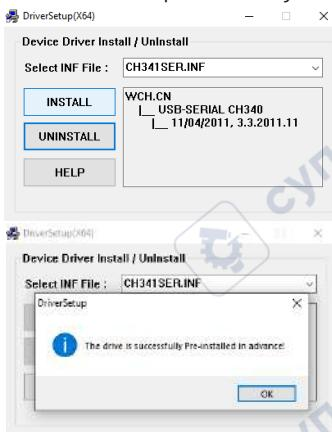
Подключите USB-кабель к ПК, не подключая прибор к нему. Windows обнаружит и установит устройство. При правильной установке драйвера в диспетчере устройств, в разделе «Порты COM и LPT» появится порт «USB-SERIAL CH340», как на картинке. Нумерация порта может быть другой, запомните его номер. Отключите кабель от ПК.
