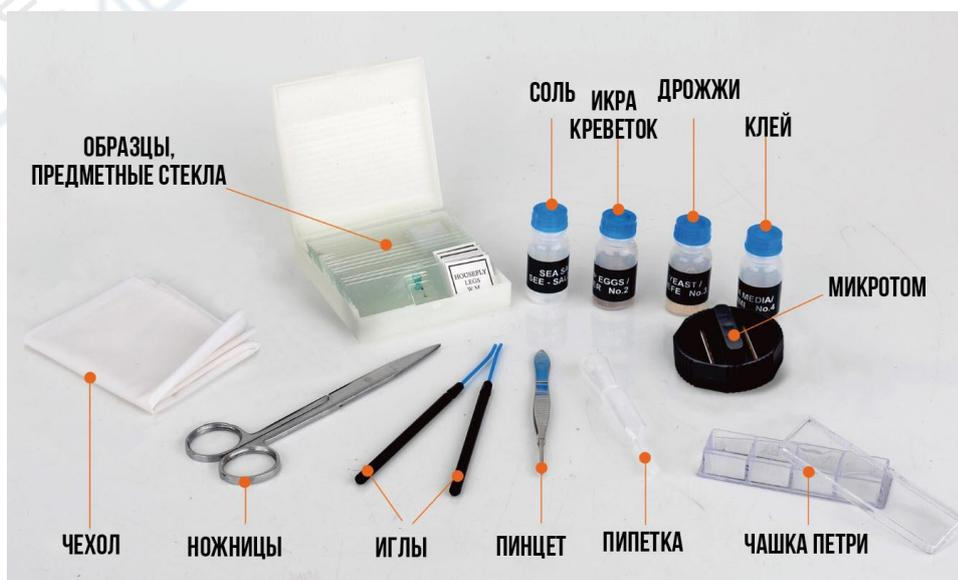
К учебным микроскопам в комплекте поставляются инструменты, набор образцов и материалы для проведения наблюдений (для разных моделей комплектующие могут отличаться). Вы сможете провести опыты, приготовить препараты самостоятельно с помощью микротомы или изучить уже готовые образцы, например, срезы со стеблей и корней растений.
