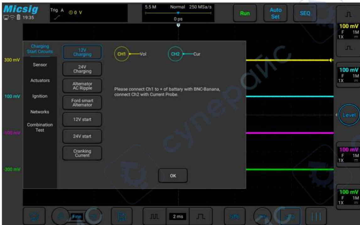
Рис. 15. Проверка генератора 12 В.
