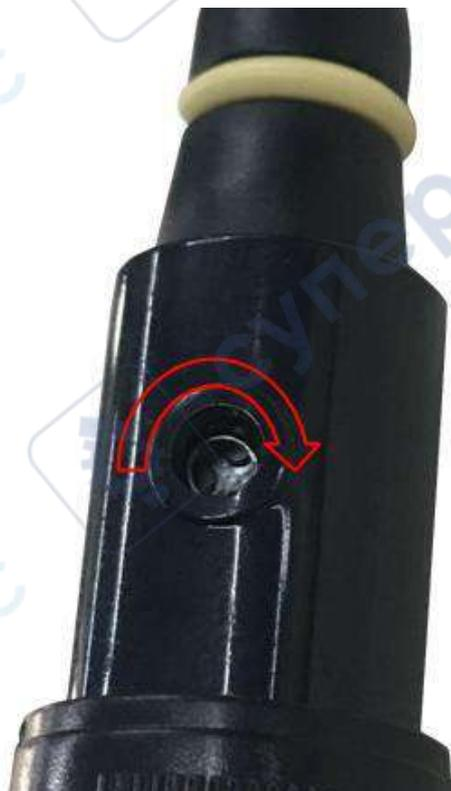
Рис. 14. Регулировка компенсации щупа.
