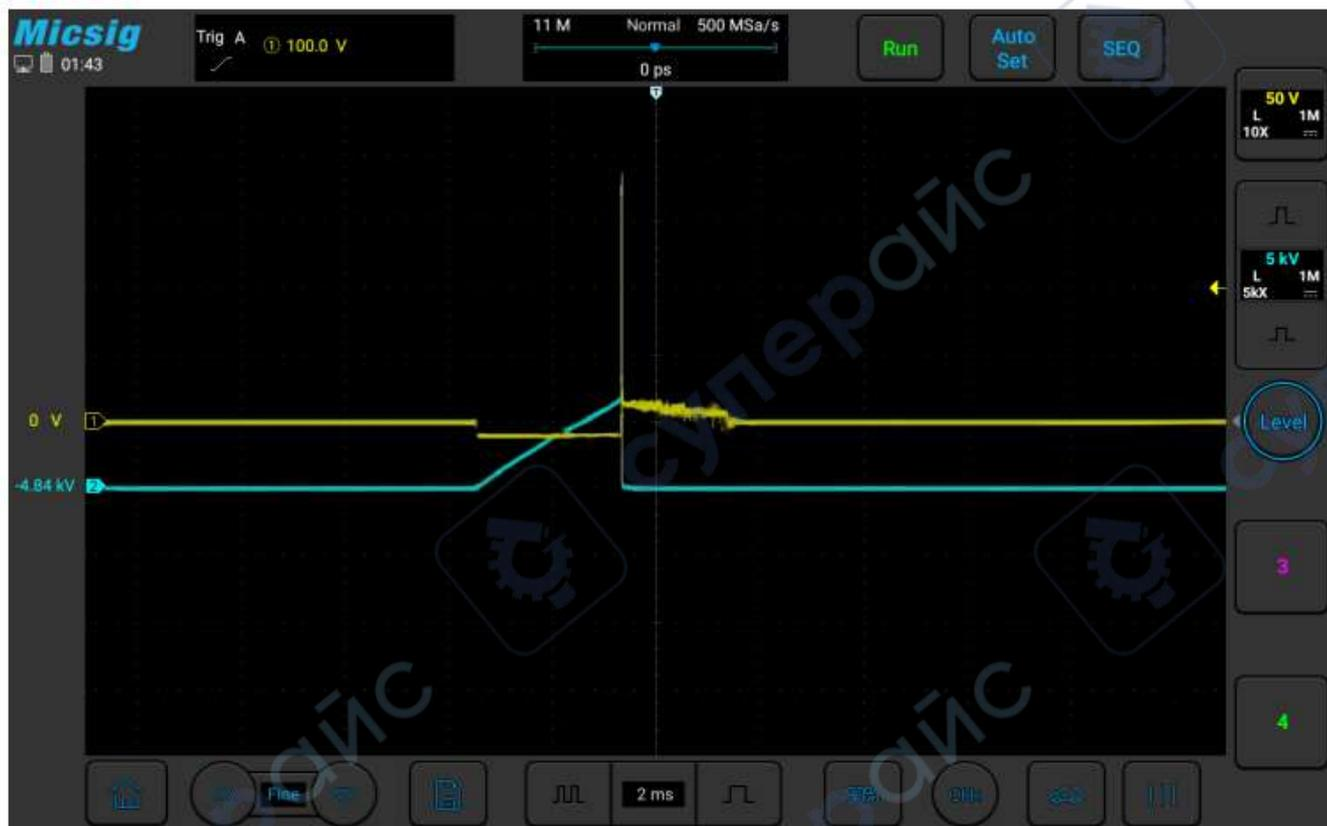
Рис. 27. Пример проверки первичной и вторичной цепей зажигания BMW 5 с двигателем N20.
