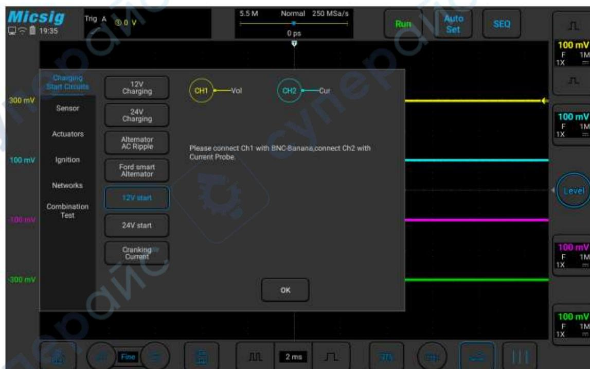
Рис. 16. Оценка пускового напряжения 12 В.
