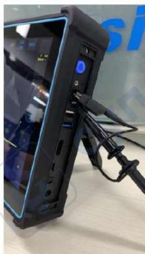
Рис. 12. Подключение щупа для настройки компенсации.
