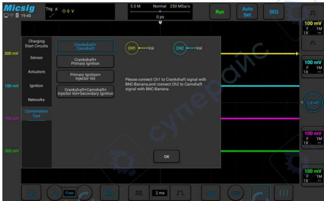
Рис. 30. Комплексная проверка датчиков коленвала и распредвала.
