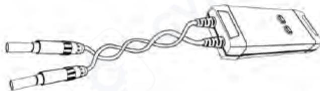
2. Удлинение входных проводов может привести к появлению большего шума во время измерений. Если требуется удлинить провод, убедитесь, что удлинительные провода одинаковой длины и частота входного сигнала меньше 10 МГц. В противном случае могут возникнуть ошибки измерений.
