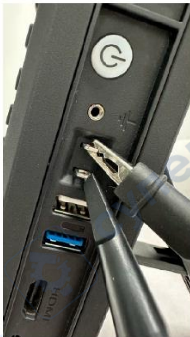
Рис. 11. Подключение щупа для настройки компенсации.
