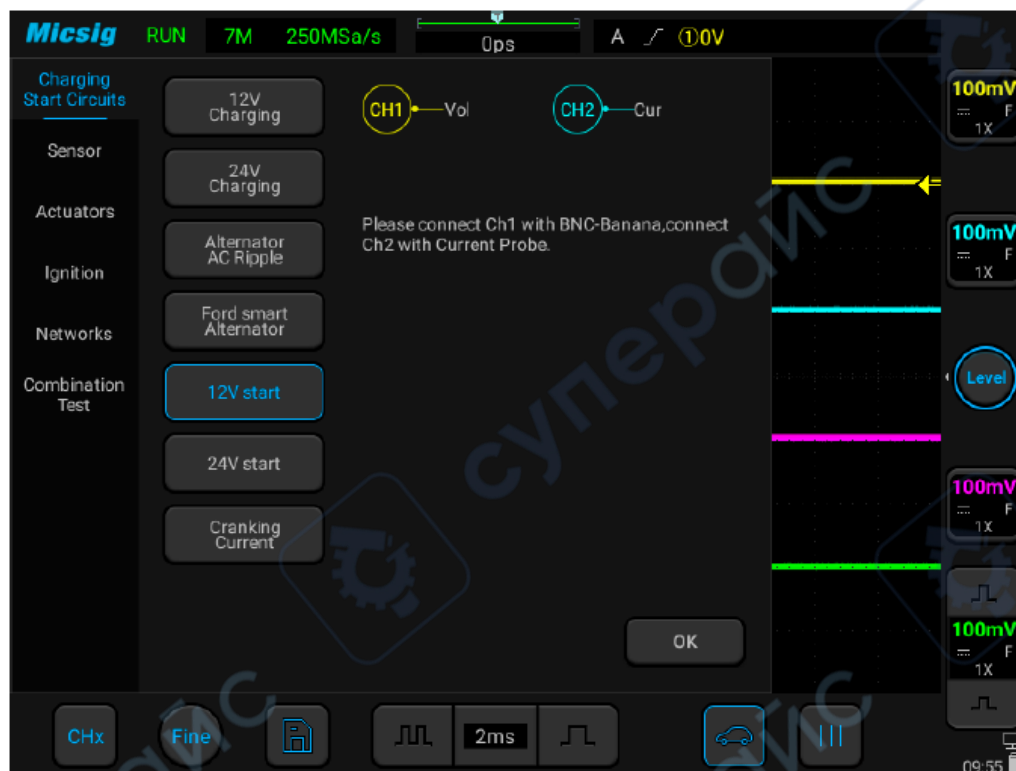
Рис. 15. Оценка пускового напряжения 12 В.
