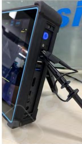
Рис. 11. Подключение щупа для настройки компенсации.
