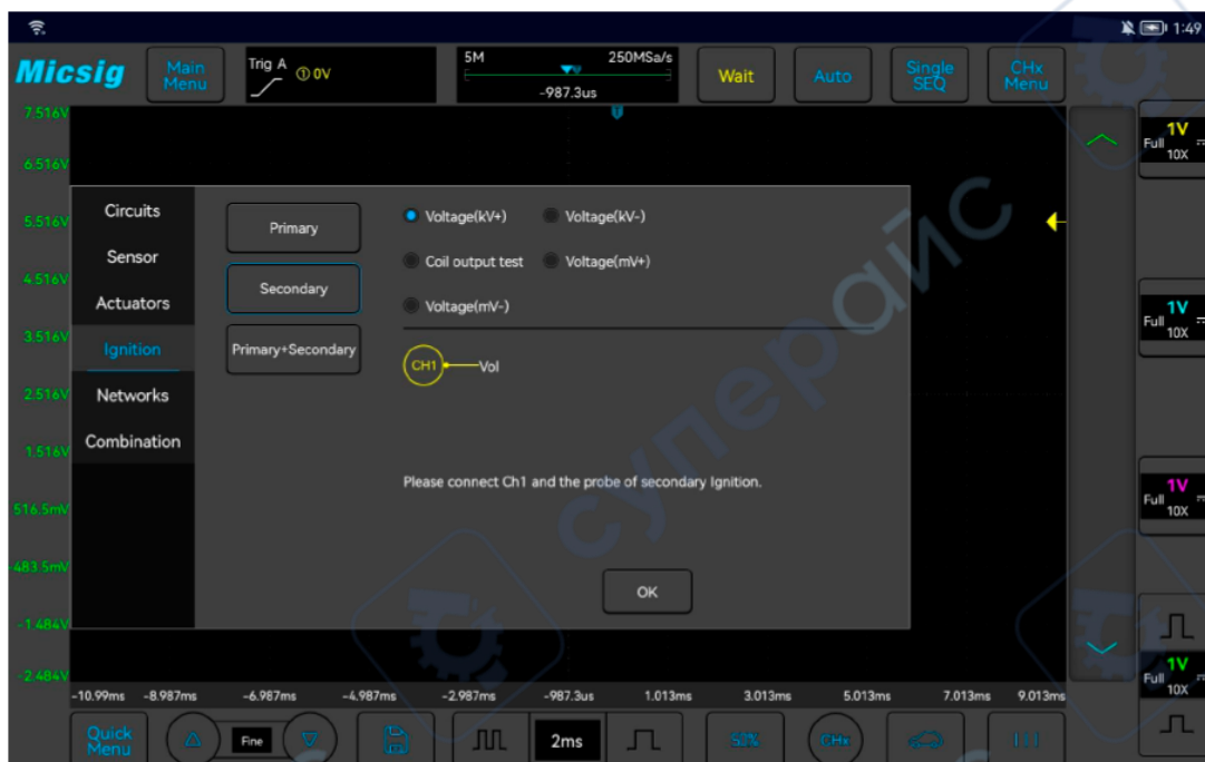
Пример окна измерений вторичной цепи зажигания.
