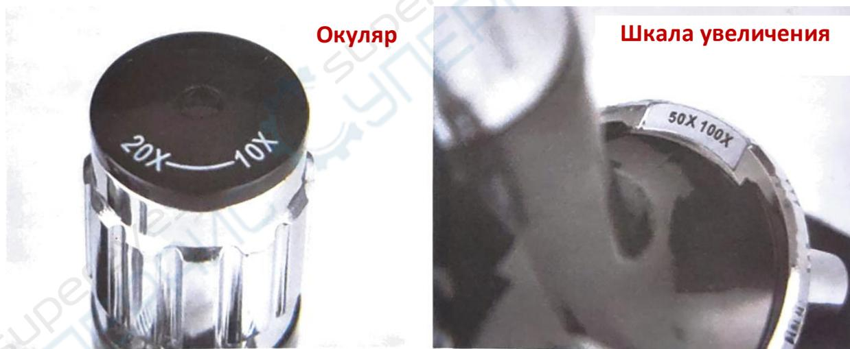
Данный микроскоп имеет шесть возможных кратностей увеличения: 50X, 100X, 200X, 400X, 600X, 1200X.
