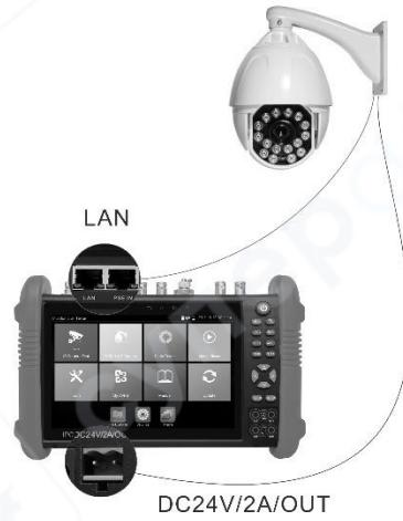
При нажатии «On», выходное напряжение 24В и мощность отображаются в режиме реального времени.
