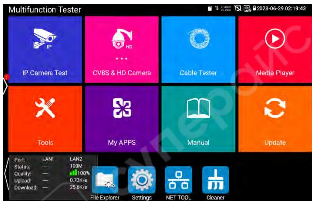
Если для подключения к гигабитному устройству используется 4-жильный кабель, появится уведомление «the link limited» (соединение ограничено).
