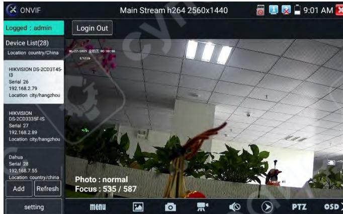
Если выбран режим **ONVIF Rapid**, прибор автоматически сканирует различные сегменты сети на наличие камер ONVIF. Имя камеры и IP-адрес отображаются в «**Device List**» (Список устройств). Тестер может автоматически войти в камеру и отобразить изображение.
