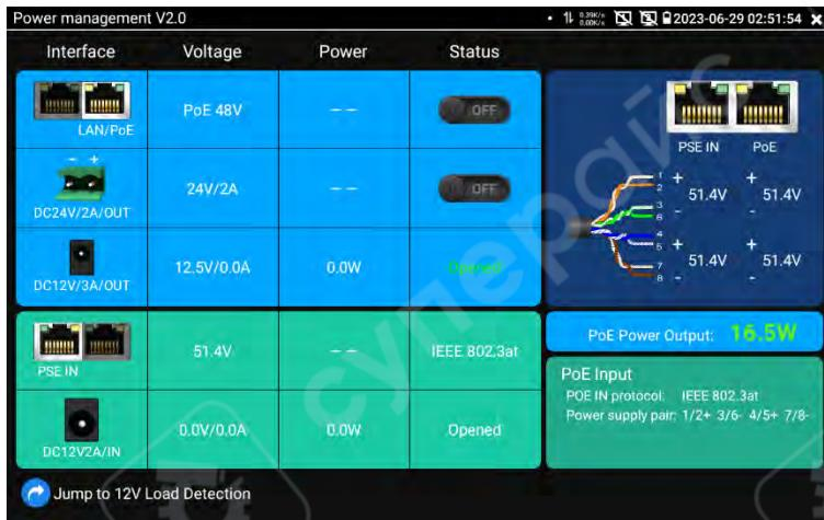
**Примечание:** Этот тест предназначен для измерения напряжения, потребляемого узлом PoE. IP-тестер должен находиться между PoE-коммутатором и узлом PoE для корректной работы теста.
