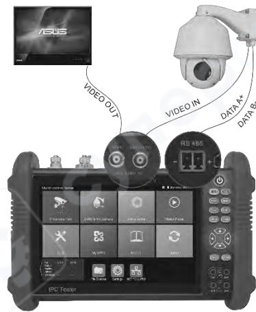
1) Камера (видеовыход другого устройства) подключается к разъёму «VIDEO IN» тестера. После нажатия кнопки PTZ, На дисплее тестера должно появиться изображение.
