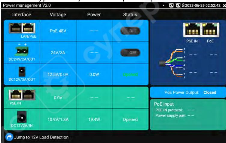
**Предупреждение:** Не допускается подключение устройства с входным напряжением более 17В к порту **«12V IN»**, это приведет к повреждению прибора.
