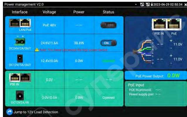
После выхода из экрана «DC 24V» питание 24В продолжает подаваться, и в плавающем окне прибора отображается надпись «**24V is on**», пока прибор не перейдет в спящий режим или пользователь не вернется на экран «DC 24V» и не нажмет кнопку отключения питания.
