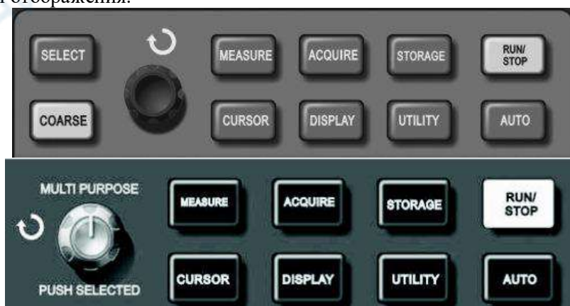
Рисунок 2-22. Функциональная кнопка настройки дисплея (DISPLAY) в зоне системы выборки данных
