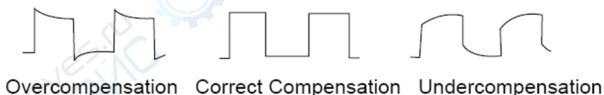
Рисунок 1-8. Коррекция компенсации щупов.
