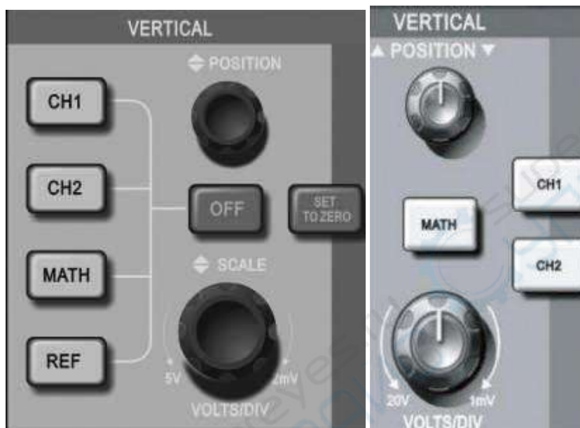
Рисунок 1-9. Зона управления вертикальной шкалой на панели управления осциллографов с 5,7-дюймовым дисплеем (слева) и 7-дюймовым дисплеем (справа)
