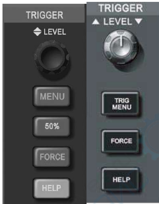
Рисунок 1-11. Зона управления запуском на панели управления осциллографов с 5,7-дюймовым дисплеем (слева) и 7-дюймовым дисплеем (справа)
