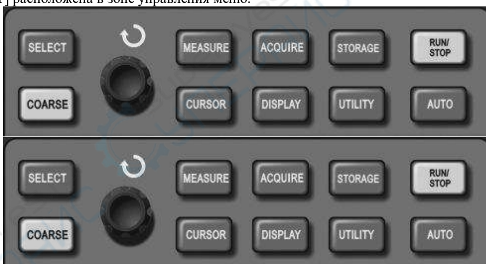
Рисунок 2-28. Функциональная кнопка вызова вспомогательных функций (UTILITY) в системе выборки данных
