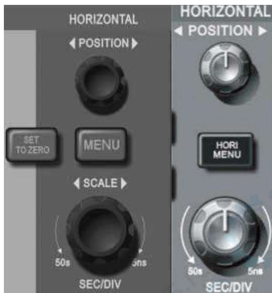
Рисунок 1-10. Зона управления горизонтальной разверткой на панели управления осциллографов с 5,7-дюймовым дисплеем (слева) и 7-дюймовым дисплеем (справа)
