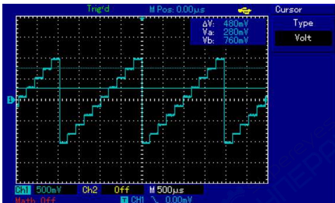
Рисунок 3-6. Курсорное измерение разности потенциалов в сигнале
