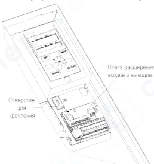
Рисунок 7.43 – Монтаж платы расширения входов и выходов
