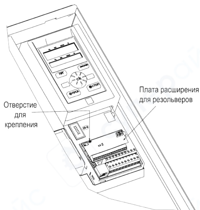
Рисунок 7.45 – Монтаж платы расширения для резольверов
