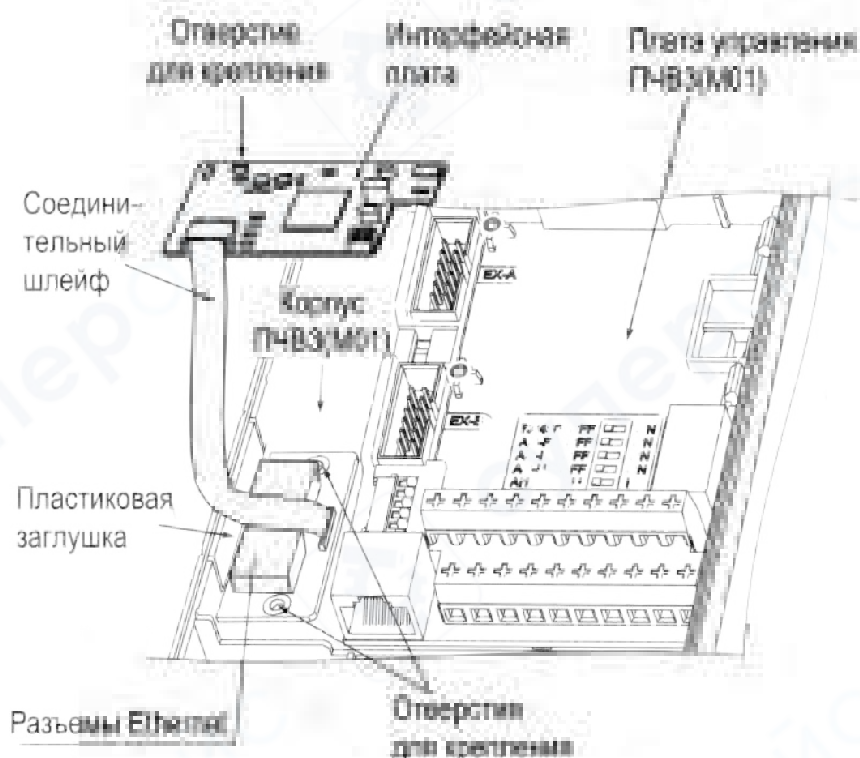
Рисунок 7.40 – Монтаж платы на преобразователях частоты мощностью 5,5 – 45 кВт
