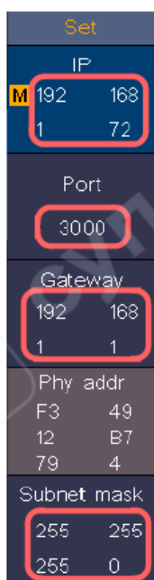
Установка сетевых параметров осциллографа
