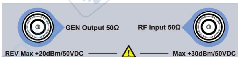
Выход следящего генератора может быть подключен к приёмнику штекером N-типа (при необходимости пользователь может приобрести его отдельно, как опцию).
