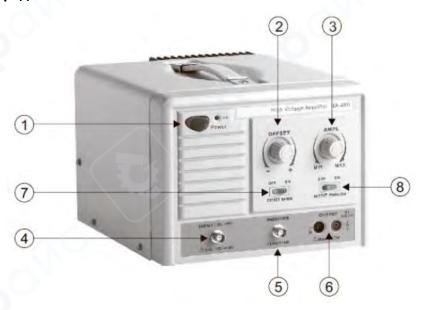
1. **Включение питания** (Power On): При включении питания загорается светодиодный индикатор.
