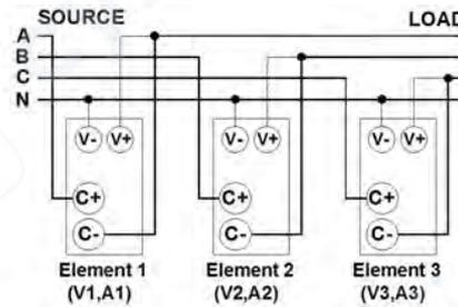
C: 3 电压 3 电流 (3V3A)
