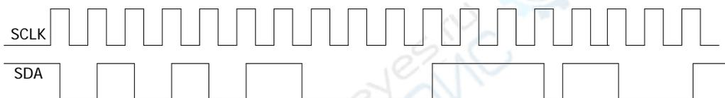
**SCLK**: дискретизация SDA производится на переднем или заднем фронте синхросигнала.
