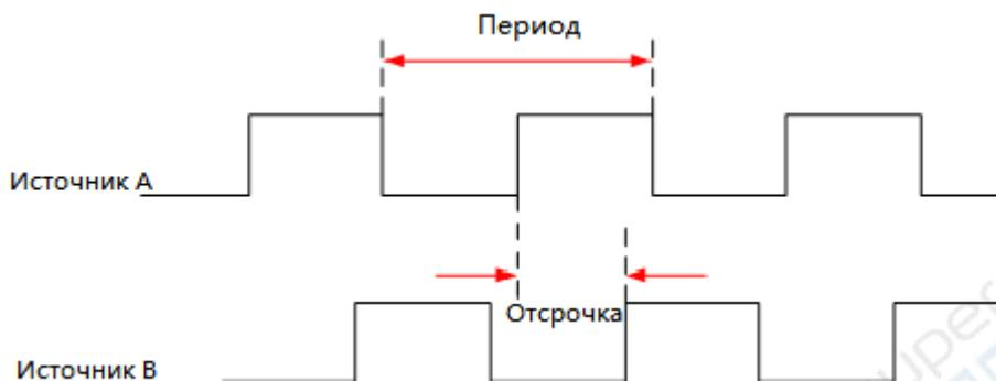
Источником А и источником В может являться любой из каналов CH1-CH4.
