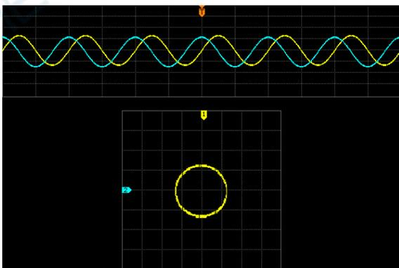
5. Расстояние от точек пересечения оси X и оси Y с видимым кругом на верхнем рисунке до начала координат приближенно равно. Таким образом, получаем фазовый угол  $\theta = \pm \arcsin 1 = 90^\circ$ .
