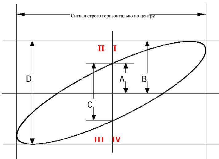
На основании  $\sin\theta=A/B$  или  $C/D$ , где  $\theta$  это фазовый угол между каналами, значения A, B, C, D см. на верхнем рисунке. Отсюда получаем фазовый угол:
