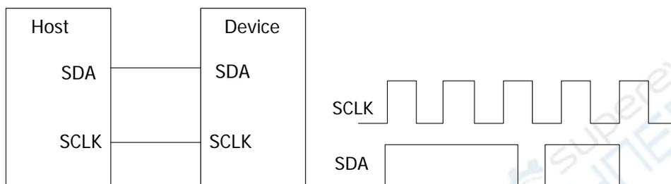
**SCLK:** дискретизация SDA на переднем и заднем фронте синхросигнала.
