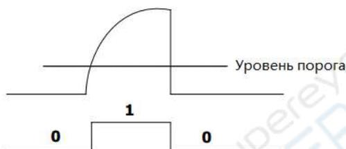
Нажмите **MATH** → **Опции декодирования** → **Автоматический порог**, включите или выключите функцию автоматического порога.
