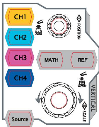
**CH1, CH2, CH3, CH4**: аналоговые каналы входа. 4 канала выделены разными цветами, а также цвета сигналов на экране и входных коннекторов соответствуют данным цветам. Нажатием любой клавиши можно открыть меню соответствующего канала, повторное нажатие закроет канал.
