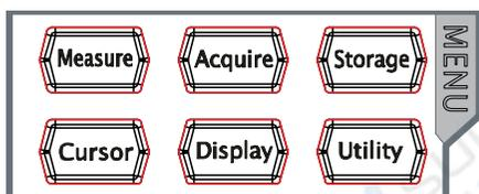
**Measure**: нажатие на данную клавишу открывает меню настройки измерений. Можно произвести настройку параметров измерений, полного измерения, функции статистики и т.д. Нажатие на **MENU** в левой части экрана откроет меню измерений по 24 параметрам волн, последующее нажатие на соответствующую клавишу меню произведет незамедлительное измерение “одной клавишей”, результаты измерений появятся в нижней части экрана.
