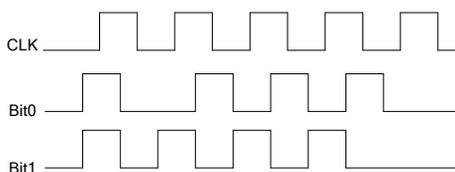
Осциллограф производит дискретизацию данных каналов на переднем фронте, на заднем фронте или переднем и заднем фронтах синхросигнала, а также в соответствии с заданным пороговым уровнем определяет каждую точку данных в качестве логической “1” или логического “0”.
