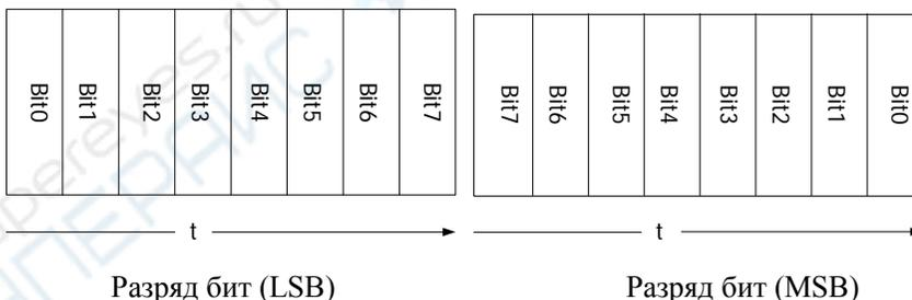
В RS232 для обозначения скорости передачи используется скорость передачи данных в бодах (т.е. количество передачи в битах на каждую сек.: бит в секунду). Часто используемые скорости передачи данных в бодах: 2400 бит в сек., 4800 бит в сек., 9600 бит в сек., 19200 бит в сек., 38400 бит в сек., 57600 бит в сек. и 115200 бит в сек.
