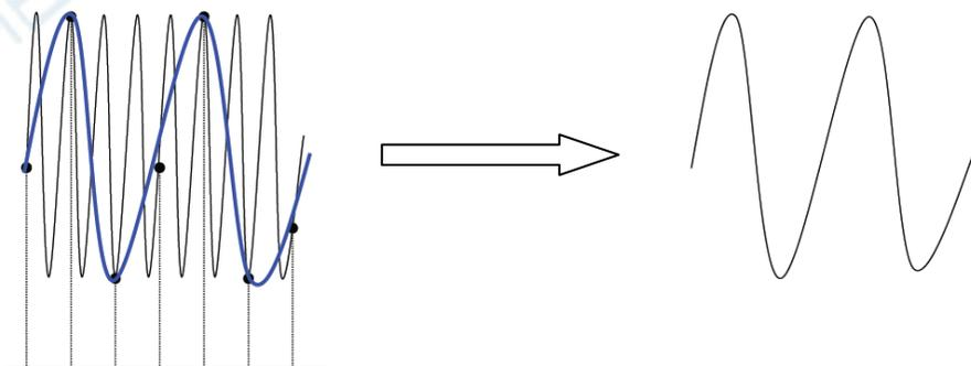
3. **Потеря сигнала:** поскольку коэффициент дискретизации занижен, сигнал во время перестройки данных дискретизации не отреагирует на все реальные сигналы.
