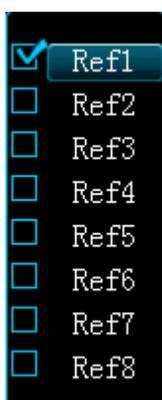
После запуска функции REF Вы можете выбрать различные цвета для различных каналов контрольных сигналов, настроить источник для каждого контрольного канала, отрегулировать вертикальную шкалу и смещение контрольных сигналов, сохранить контрольные сигналы на встроенную или внешнюю память, а также при необходимости произвести повторную выборку для использования. Подробнее см. в нижеследующем описании.
