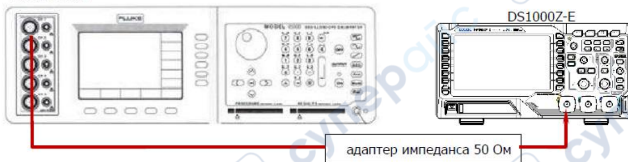
Рисунок 2-3. Схема подключения для испытания полосы пропускания
