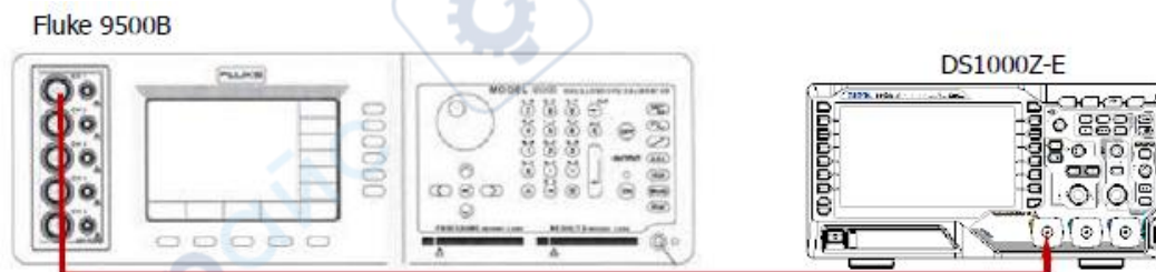
Рисунок 2-1. Схема подключения для испытания импеданса
