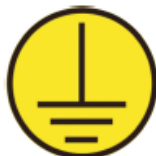
Клемма защитного заземления
