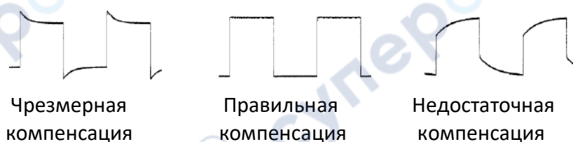
Рисунок 5. Компенсация щупа
