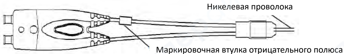
Рисунок 5 — Однотактная припаиваемая головка пробника
