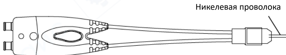
Рисунок 4 - Дифференциальная припаиваемая головка пробника
